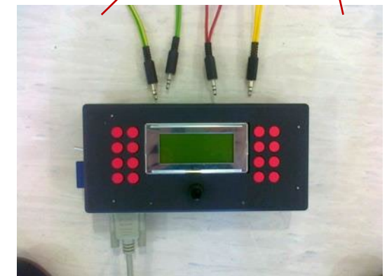
A PPKE ITK-n fejlesztett sokcsatornás izomingerlő készülék
