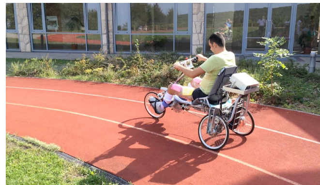
FES vezérelt kerékpározás denervált izomzatú páciens számára
